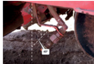
Правильна установка розпилювача — 45–55 градусів від вертикалі
